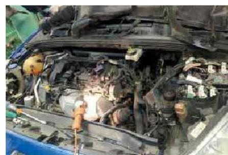
Рис. 4. Демонтаж сопутствующего оборудования
