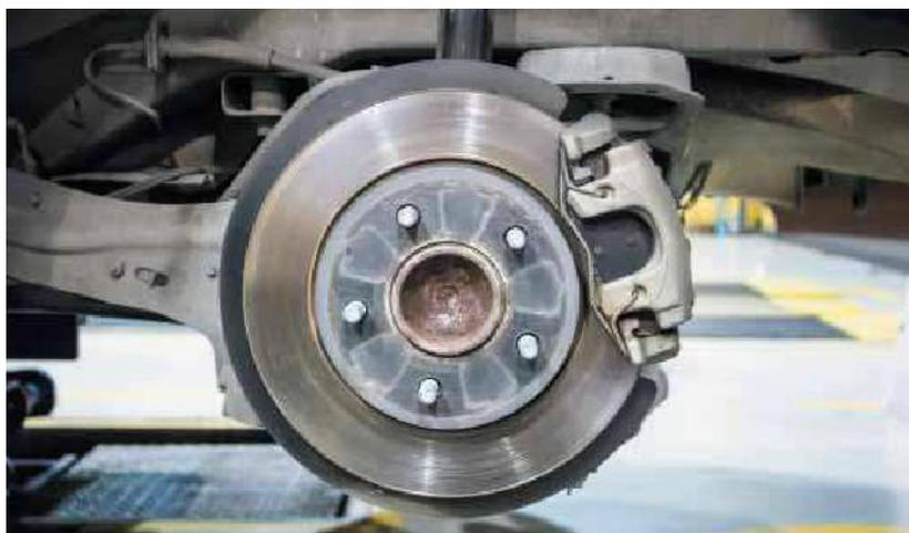
торов износа, что свидетельствует об износе колодок (понять это можно визуально, оценив толщину фрикционного материала). Тут вроде все понятно и просто.
