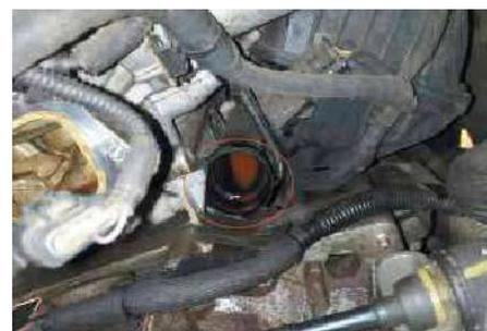
Рис. 5. Посадочное место термостата в отводной трубке
