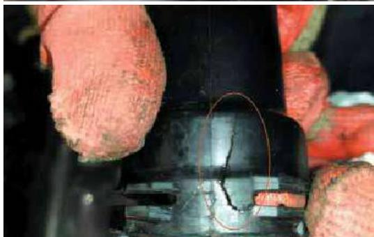
**Рис. 16.** Трещина в отводной трубке
