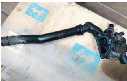
**Рис. 17.** Трубка с термостатом
