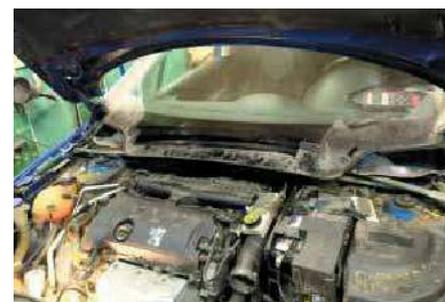
Рис. 10. Панель стеклоочистителя демонтирована
