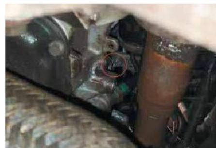
Рис. 13. Посадочное место нижнего болта впуска
