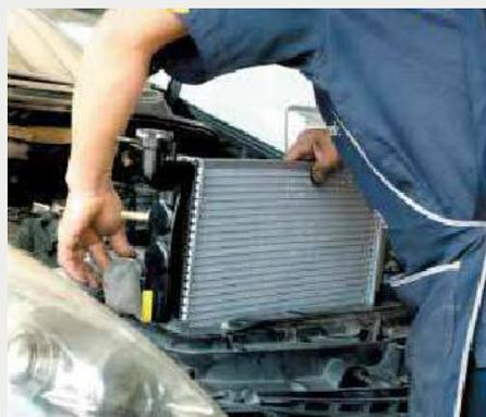
При использовании на автомобилях радиаторов, изготовленных из алюминия, имеются некоторые особенности, связанные с их техническим обслуживанием. Основное отличие заключается в предохранении алюминиевых радиаторов от коррозии. Это обусловлено различной коррозионной стойкостью алюминия и меди в кислых и щелочных средах: для алюминиевых более опасны щелочные среды, а для медных — кислые.
